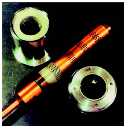
Den hullede plug, trimmets inderste del med huller (cagen) samt ventilens yderste del.
